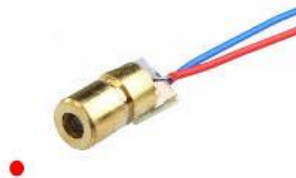
Diodo laser concentra toda la luz en un punto
