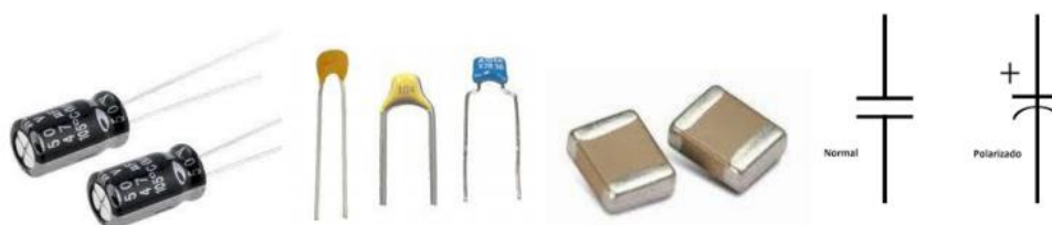
Diferentes tipos de condensadores y su simbología
