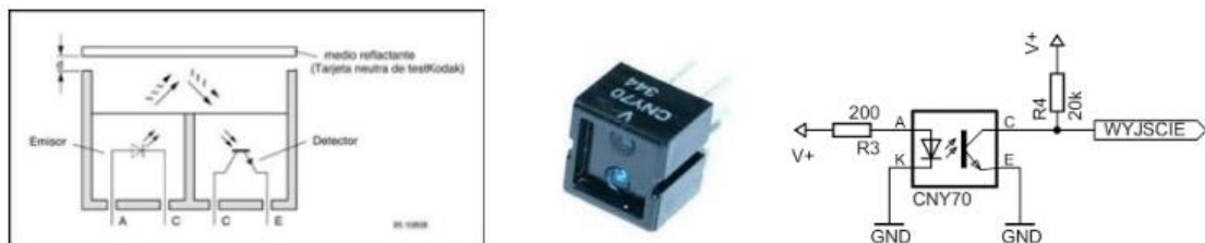
Estructura interna y composición del sensor óptico CNY70
