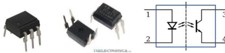
Diferentes tipos de optoacopladores y su simbología
