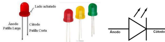
Estructura física del diodo Led y simbología
